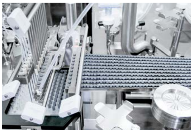
↑ Finale Station: Die Tubs werden mit einem Code bedruckt und dessen Vorhandensein geprüft.
