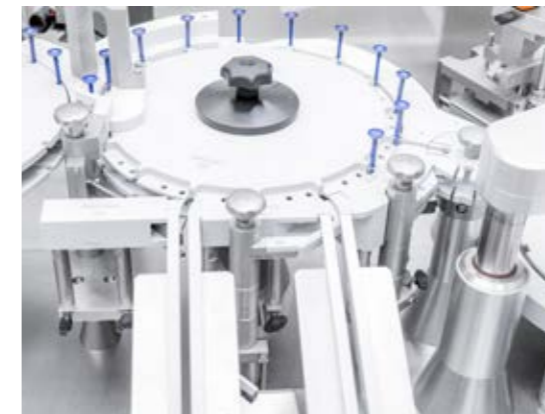
Drei Optionen: Aktiver Gut- und Schlechtausschub sowie der optionale Weitertransport zur Magazinierung der Fertigspritzen.
