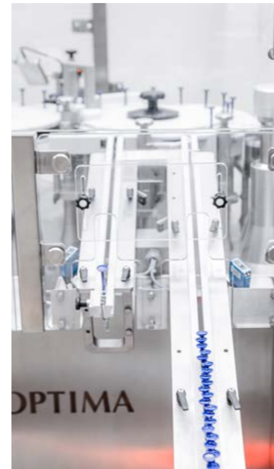
↑ Auch die Spritzenmontagelinie mit Etikettierer ist formatflexibel aufgebaut.
