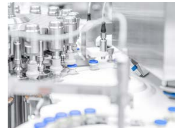
Die Anwesenheit der Bördelkappen wird geprüft.
