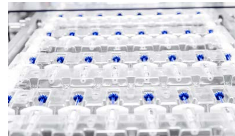
↑ Finale: Sicherheitskomponenten sind montiert, die Fertigspritzen etikettiert, bedruckt und automatisch in Trays magaziniert.
