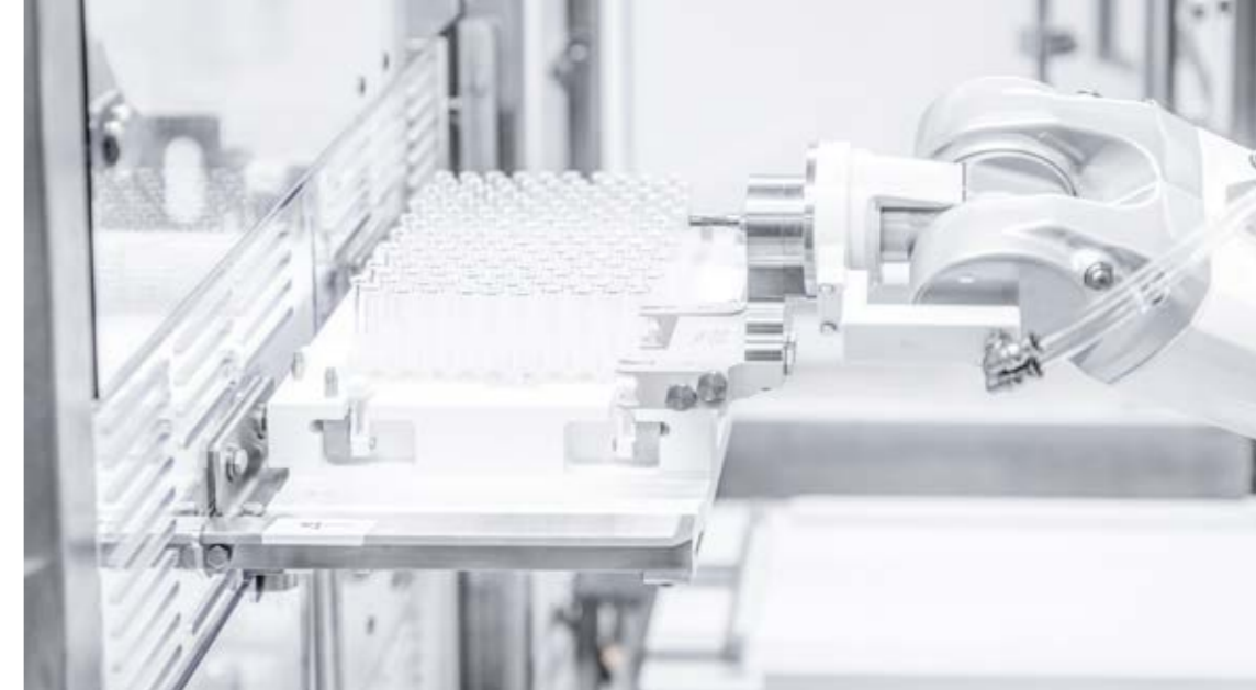
→ Der Roboter nimmt Behältnisse für die Einzelverarbeitung auf: Die MultiUse LAB beherrscht Fertigspritzen, Karpulen und Vials.
