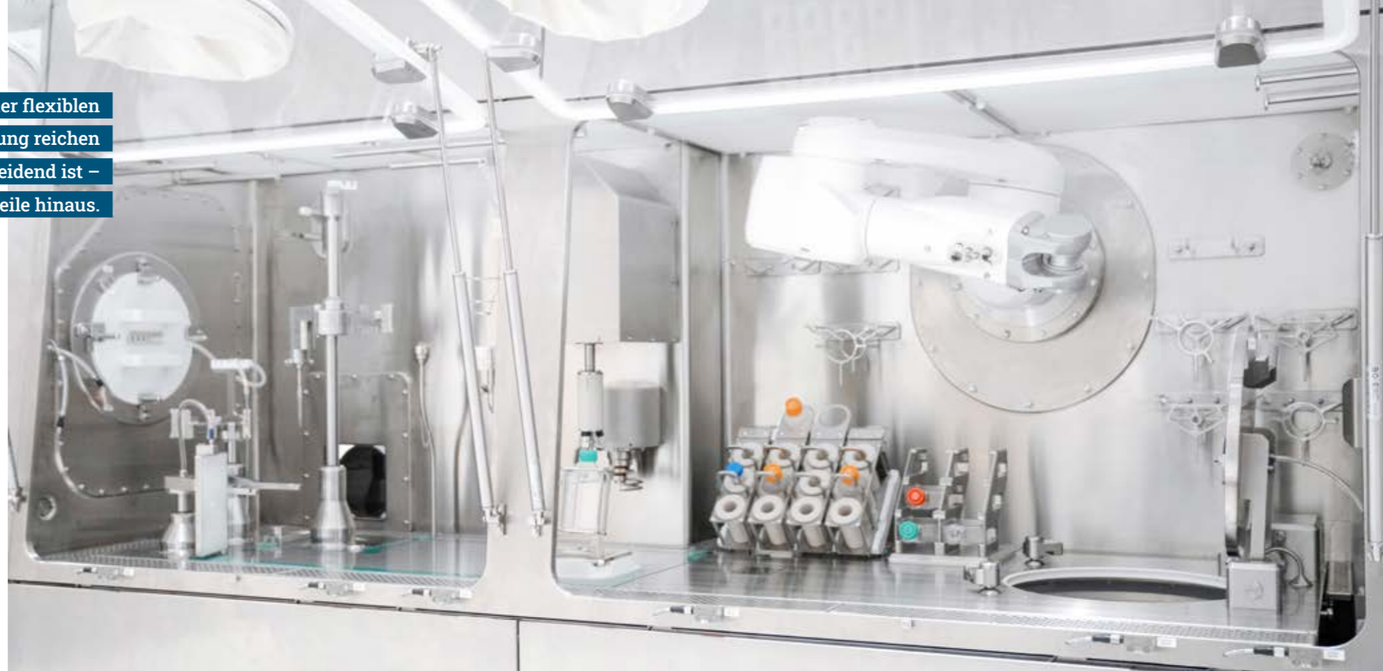
← Viele CAR-T-Zelltherapien unterscheiden sich in den Herstellungsprozessanforderungen und -abläufen erheblich voneinander. Die OPTIMA ProCell bietet die Flexibilität, all dies abzubilden.
