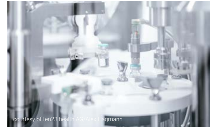
↑ Verschließprozess für Vials: Genauso werden in der Pilotanlage MultiUse LAB Fertigspritzen und Karpulen verschlossen und dabei Toleranzen kontrolliert.
