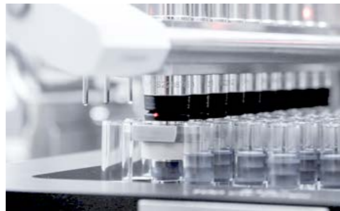
Füllen und Stopfensetzen kombiniert in einem Modul. ↓
