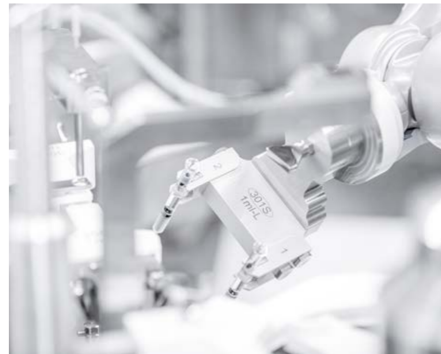
Fertigspritzen, Karpulen und Vials auf der MultiUse LAB. Optionen wie ein dreistufiges Vakuum sorgen für spezifisch anpassbare Füll- und Verschließprozesse.
