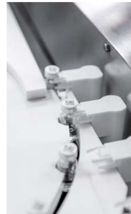
Die Vials erhalten einen Data-Matrix-Code auf die Aluminiumkappe aufgedruckt, der noch in der Anlage mit Kameras kontrolliert werden kann.
