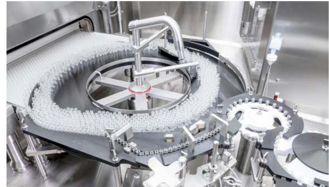
Drei Optionen: Aktiver Gut- und Schlechtausschub sowie der optionale Weitertransport zur Magazinierung der Fertigspritzen.
