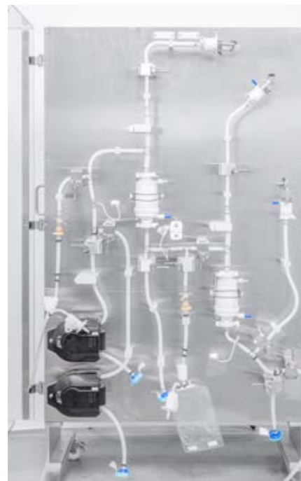
PUPSIT-Filtertests an der Anlage: Die installierten Produktfilter werden vor und nach einem Batch auf Unversehrtheit geprüft. →
