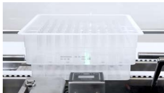
↑ Finale Station: Die Tubs werden mit einem Code bedruckt und dessen Vorhandensein geprüft.
