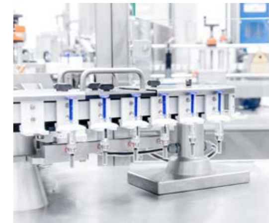
← Anwendungsbereit und mit Schutzkomponenten gesichert: Die Spritzenmontagelinie beinhaltet weitere Prozesskontrollen.
