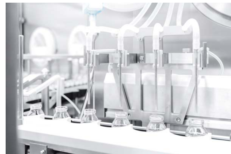
↑ Bis zu 5.000 Vials werden pro Stunde verarbeitet. Produktsparfunktionen schöpfen die vorhandene Menge der Arzneimittel optimal aus.
