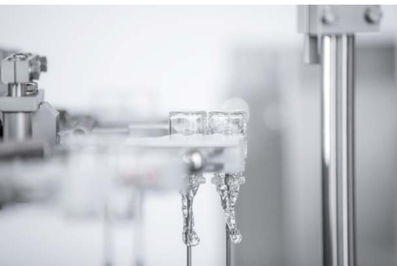
↑ Im ersten Schritt werden die Vials in einer Waschmaschine gereinigt.
